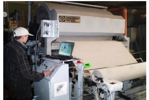
*Наличие системы контроля и управления качеством бумаги, обеспечивает равномерность и высокое качество бумажного полотна. При этом ведется постоянная запись всех получаемых данных в базу данных. Программное обеспечение позволяет использовать сеть Интернет для постоянного контроля руководителем работы бумагоделательного производства.*
