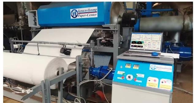
Плоскосеточное оборудование отличается от круглосеточного (цилиндровых машин) способом создания бумажного полотна. Плоскосеточные машины дают возможность для создания более мягкой и прочной бумаги толщиной от 14г/м2 до 45 г/м2 (и более), машины с круглой сеткой производят бумагу менее прочную и ее характеристики более узкие.
