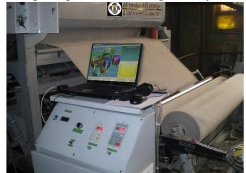
Для измерения скорости намотки наката, машины, длины наматываемого рулона, крепа используется интеллектуальный микропроцессорный контроллер с протоколом связи с компьютером RS-232.
