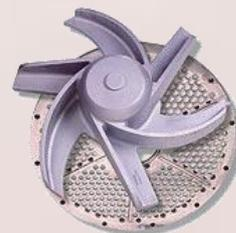
В нижней части ванны установлен роторный агрегат. Роторный агрегат состоит из корпуса, в котором на подшипниковых опорах установлен вал. Корпус крепится к приемной камере присоединяемая к ванне. Крылатка установлена на валу консольно. Под крылаткой на приемной камере расположено сито.
