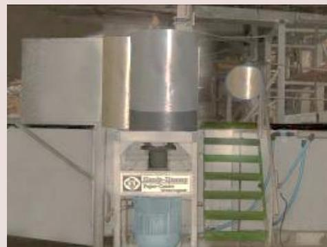
Роторный агрегат состоит из корпуса, в котором на подшипниковых опорах установлен вал. Корпус крепится к приемной камере присоединяемая к ванне. Крыльчатка установлена на валу консольно. Под крыльчаткой на приемной камере расположено сито. Распущенный волокнистый материал проходит через сито в приемную камеру и удаляется из гидроразбивателя.
