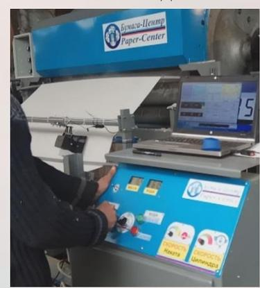
Для измерения скорости намотки наката, машины, длины наматываемого рулона, крепа используется интеллектуальный микропроцессорный контроллер с протоколом связи с компьютером RS-232.
