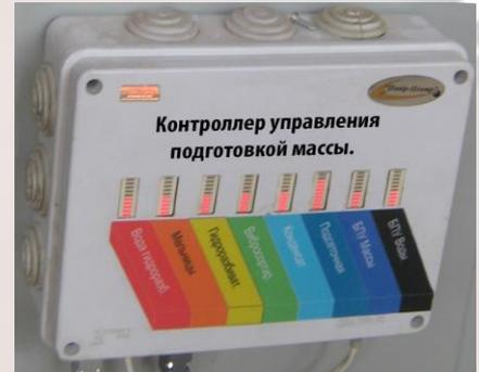
За состоянием уровня следят датчики уровня, установленные в баке и передают эту информацию в центральный компьютер.
