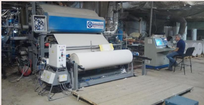
требуется при тех же показателях до 40 % энергии. В результате таких показателей удалось, используя малую поверхность сушильного цилиндра (диаметр цилиндра всего 1500 мм) добиться высоких показателей производительности. Этот метод и конструкция скоростной конвективной сушки бумажного полотна запатентовано и на практике доказано ее эффективность.
