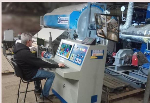
Нагрев сушильного цилиндра (Янки-цилиндра) производится насыщенным паром. Пар попадая внутрь сушильного цилиндра конденсируется на рабочей поверхности отдавая ей тепло одним из самых эффективных способов и с высочайшим для тепловых процессов КПД. Конденсат собирается внизу сушильного цилиндра и в виде горячей воды возвращается обратно в теплогенератор. Этот процесс является самым экономичным процессом сушки бумажного полотна.
