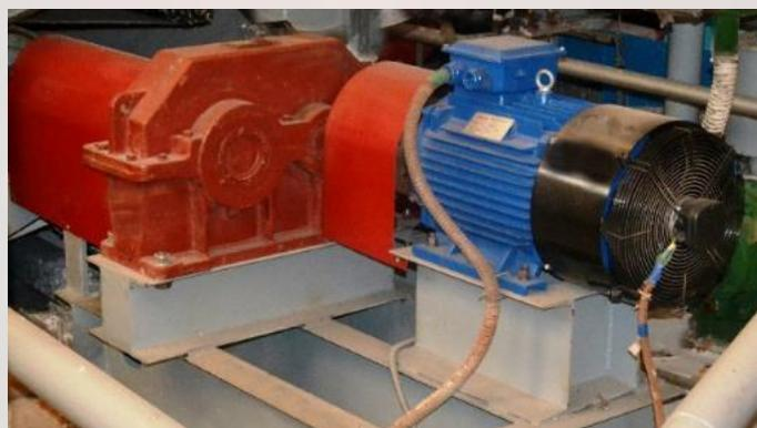
Основной привод бумагоделательной машины регулируемый частотный трехфазный. Асинхронный электродвигатель с независимым охлаждением приводит через редуктор и карданную передачу во вращение прессовый вал и через редуктор и цепную передачу
