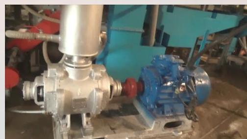
**Электродвигатель вакуумного комплекса оснащен токовым измерительным датчиком с цифровым выходом типа RS-485.** Информация с этого датчика передается по каналу связи в центральный компьютер для записи в журнал и обработки этой информации. По изменению
