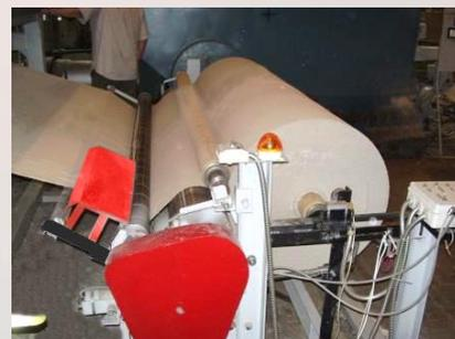
Накат имеет собственный регулируемый частотный привод, который позволяет сделать асинхронизацию линейной скорости между накатом и Янки-цилиндром, которая необходима для поддержания степени крепирования.
