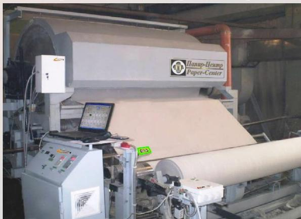
Контроллер управления накатом связан по цифровому протоколу с компьютером, что позволяет делать выгрузку намотанного рулона бумаги автоматически по достижению определенного диаметра, веса, длины намотанной бумаги, через определенное время или по команде оператора.
