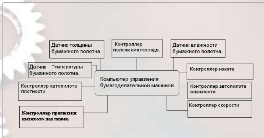
Система компьютерного управления бумагоделательным производством.
